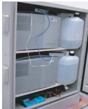
③ 風力・風向観測用燃料電池電源（200日連続運転）
