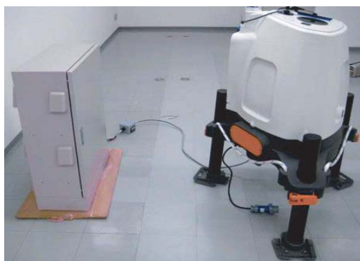
③ 風力・風向観測用燃料電池電源（200日連続運転）
